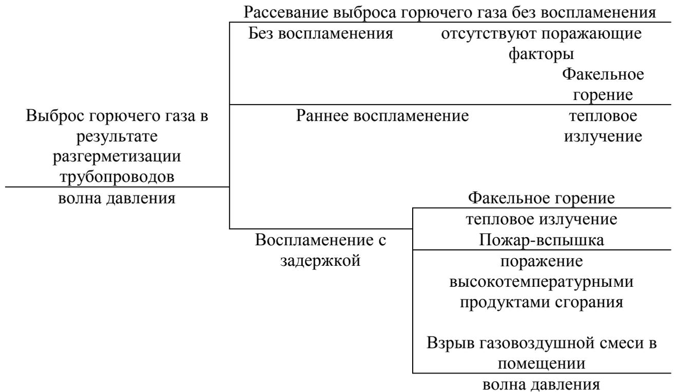
При проведении оценки пожарной опасности горящего факела при струйном истечении сжатого горючего газа (природный газ) в соответствии с положениями п. 25, п. 29 Приложения 3 к Методике принято следующее:
